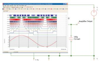
Leistungen durch einfaches Anklicken eines Punktes im Schaltbild erzeugt werden. Eine erneute Simulation ist nicht nötig wenn man einen weiteren Messpunkt benötigt. Alternativ können Messpunkte der Schaltung dauerhaft hinzugefügt werden so dass eine Grafik erzeugt und während der Simulation ständig erneuert wird.
