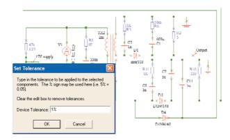
Simulation, bei der Bauteile innerhalb bestimmter Toleranzen arbeiten. Die prozentuale Toleranz wird eingegeben und die Schaltung wird mehrfach berechet, wobei die Bautelwerte bei jedem Durchlauf innerhalb des Toleranzbereiches automatisch variiert werden. Die resultierenden überlagerten Wellenformen ermöglichen dem
